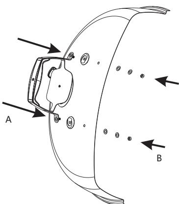
**13. Das Thermometer (2) am Deckel (3) befestigen. Teile an der Deckelinnsseite in folgender Reihenfolge anbringen: Unterlegscheibe, Sprengring, Flügelschraube.**
