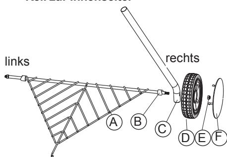
6. Die Radbeine (10,13) und das Bodengitter (11) an der Feuerschale (9) befestigen.
