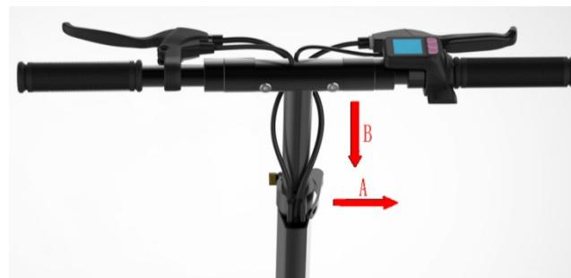
Lösen Sie dazu den Schnellverschluss (#6) indem Sie den Hebel öffnen (siehe Abbildung A). Schieben Sie dann die Lenkerstange nach unten in die niedrigste Position (siehe Abbildung B). Schließen Sie den Schnellverschluss dann wieder.
