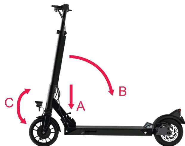
Der Winkel des Vorderlichts kann verstellt werden (siehe C in nebenstehender Abbildung). Wenn Sie das Licht nach unten drücken, leuchtet es den Untergrund kürzer vor dem Scooter aus. Wenn Sie es mehr nach oben ziehen, geht der Lichtkegel weiter nach vorne.
