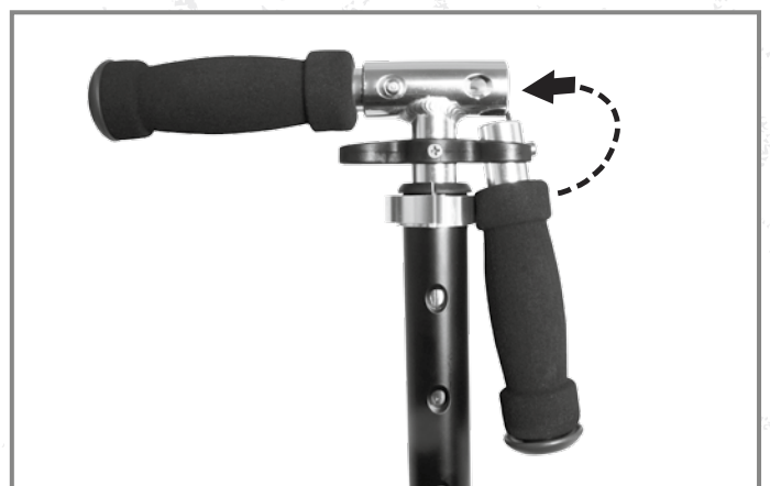
Führen Sie die Griffe des Scooters in den Lenkerkopf ein, bis der Klickverschluss einrastet.
