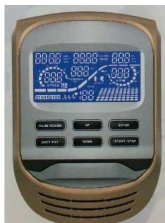
benutzen), gibt der Computer einen Ton von sich und zeigt im Rahmen einer Selbstkontrolle sämtliche Darstellungsmöglichkeiten im Display an (siehe nebenstehende Abbildung). Danach befindet sich der Computer im manuellen Modus.
