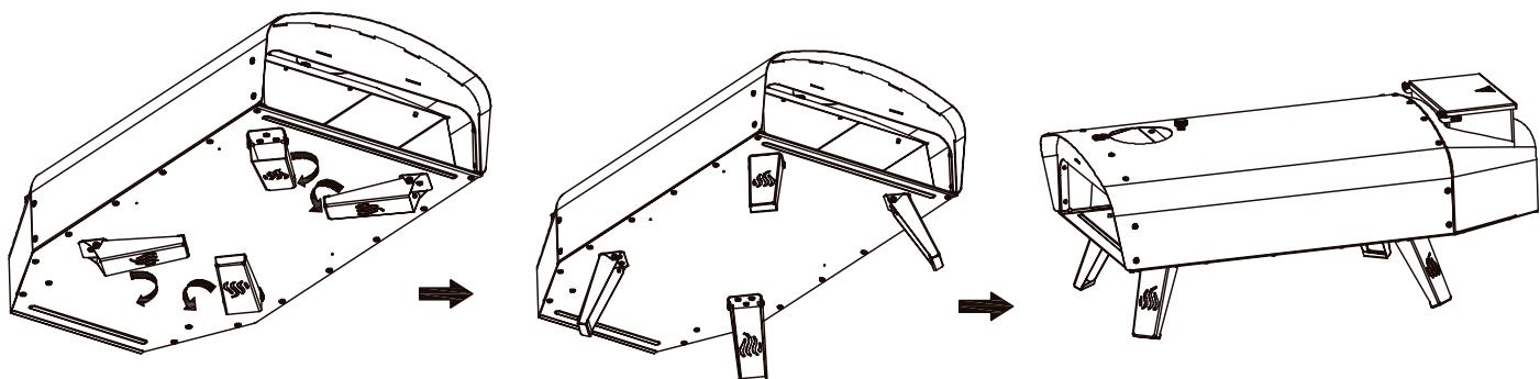
Klappen Sie die vier Standbeine vollständig aus und platzieren Sie den Pellet Pizzaofen auf einer ebenen, hitzebeständigen Fläche. Achten Sie auf einen sicheren Stand! Vermeiden Sie einen Untergrund, der leicht zerkratzt werden kann.
