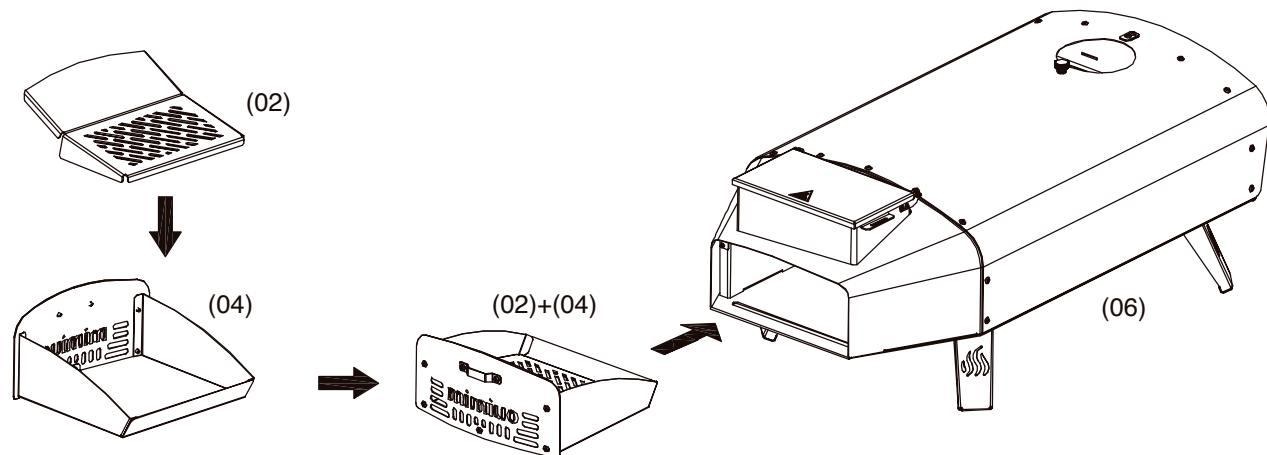
Setzen Sie die Pellet-Kammer (2) in die Ascheauffangschale (4).
