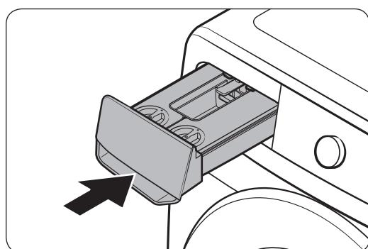
4. Schieben Sie die Waschmittelschublade wieder in die Waschmaschine hinein.
