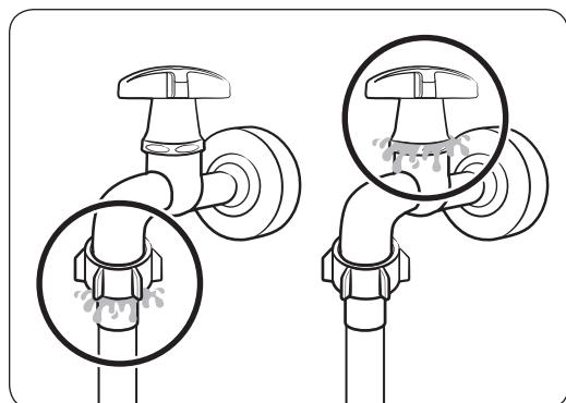
1. Verbinden Sie den Wasserschlauch mit dem Wasserhahn und drehen Sie den Überwurfring dann nach rechts fest.
