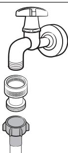
Bevor Sie den Wasserschlauch an einen Wasserhahn anschließen, müssen Sie das mitgelieferte Rückschlagventil an den Wasserhahn anschließen und dürfen erst dann den Wasserschlauch anschließen.
