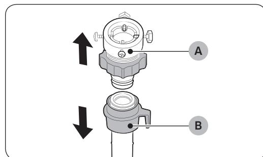
1. Entfernen Sie den Adapter (A) vom Frischwasserschlauch (B).
