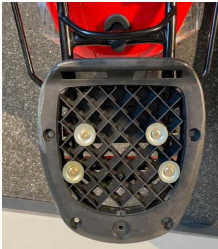
Bild 2 – fixierte Bodenplatte (Ansicht von oben)
