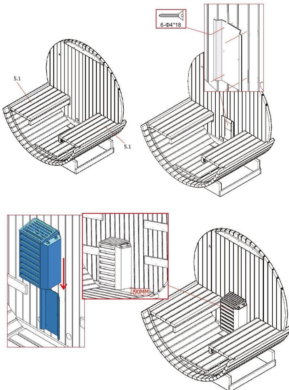
**Achtung:** Der Saunaofen **muss** in einem Abstand von 90 mm vom Fußboden an der Rückwand montiert werden
