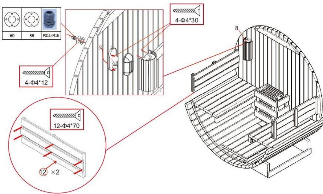
**Schritt 11: Montage Entlüftung und Glastür**
