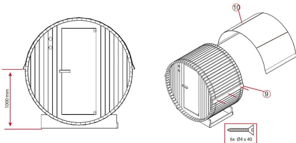
**Schritt 12: Montage der Dachfolie**
