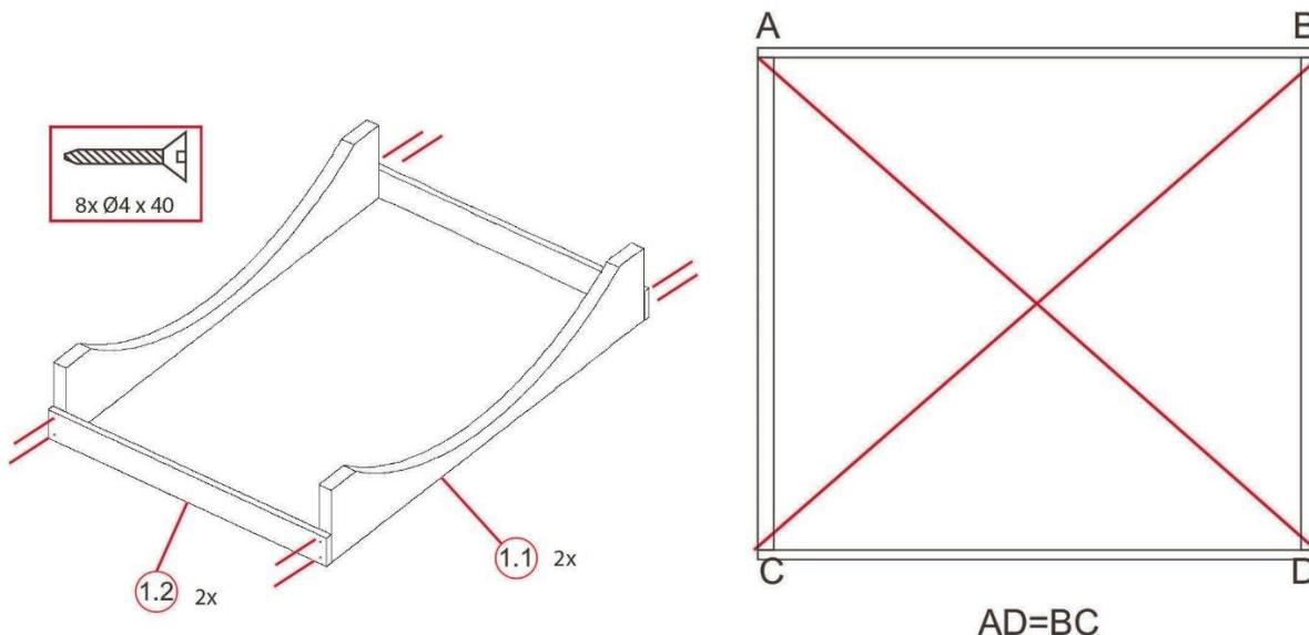
**Schritt 4: Montage des Bodens, Vorder- und Rückwand**
