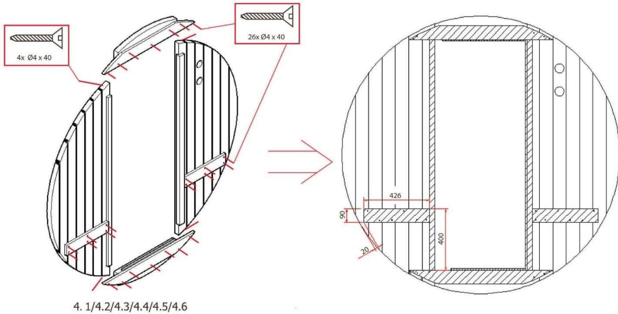
**Schritt 2: Montage der Rückwand**
