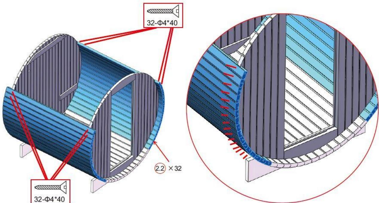
**Schritt 6: Montage der Außenwand**
