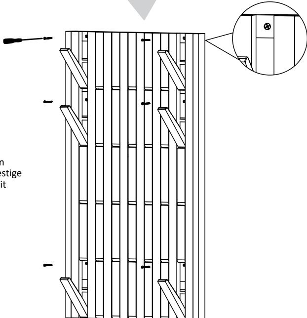
**5.** Vergewissere dich, dass die Positionen der Bohrungen mit den Dübeln übereinstimmen und befestige das Garderobenpaneel separat mit Kreuzschlitzschrauben.
