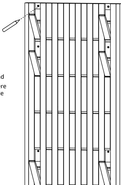
2. Öffne die 6 Arme in der gezeigten Position, zeige die Position der Montagelöcher auf der Rückseite und markiere die entsprechende Position der Löcher an der Wand, um das Bohren zu erleichtern.
