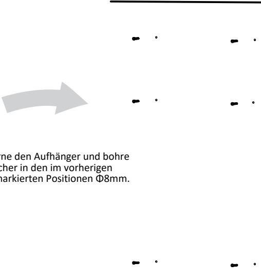
**3.** Entferne den Aufhänger und bohre dann Löcher in den im vorherigen Schritt markierten Positionen Ø8mm.
