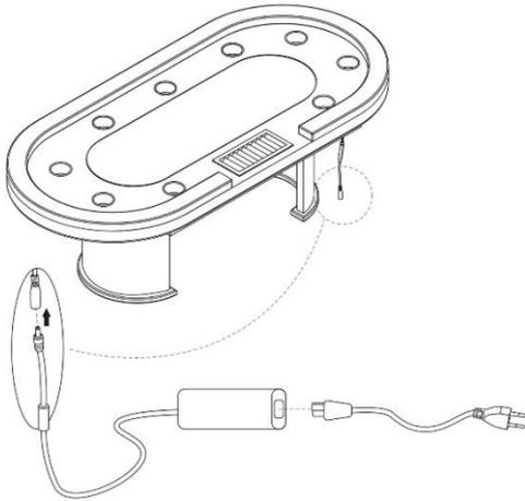
**Schritt 6:** Stecke das Schaltnetzteil in das Anschlusskabel.
