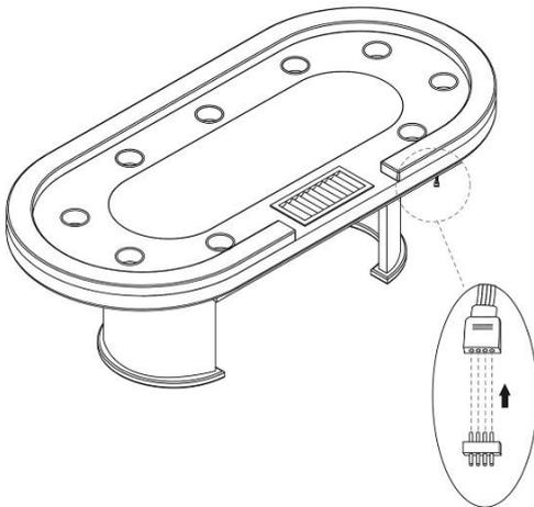
**Schritt 4:** Stecke den LED-Adapter in den Stecker der LED-Beleuchtung am Produkt.
