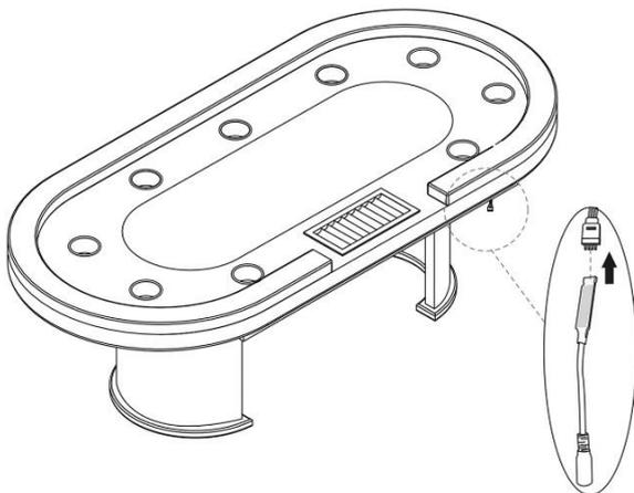
**Schritt 5:** Stecke das Anschlusskabel mit Schalter in den LED-Adapter.
