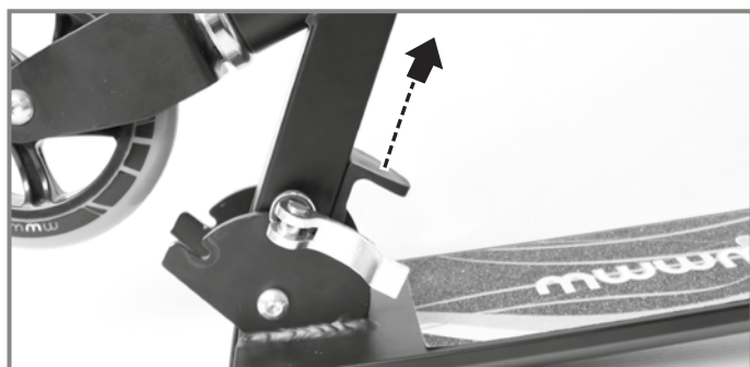
Kunststoffgriff nach oben ziehen, bis sich die Achse des Schnellverriegelungssystems aus der Halterung löst.
