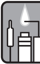
Abb. 4a: Wächterflamme brennt falsch
