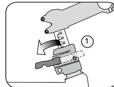
2. Drehen Sie den Lenker um 90 Grad bis die Arretierung sichtbar- und hörbar einrastet und der Verriegelungsbolzen ② am Vorbau sichtbar ist.
