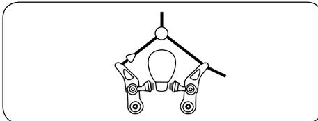
Cantilever- oder V-Bremse öffnen:
