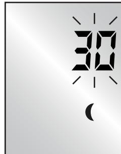
Der gewünschte Zeitversatz der automatischen Abfahrtzeit kann in 10-Minuten Schritten eingestellt werden.
