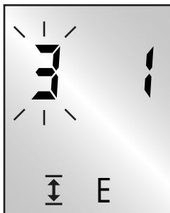
Bei aktiverter Lüftungs-funktion fährt der Rollladen, im Tages- oder Wochenpro-gramm in die programmierte Lüftungsposition. Eine Fahrt in die Endlage ist nur manuell möglich.
