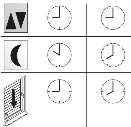
Bei eingestelltem Tages- oder Wochenprogramm und aktiver Dämmerungs- oder Astrofunktion fährt der Rollladen zum zuerst zutreffenden Ereignis herunter.
