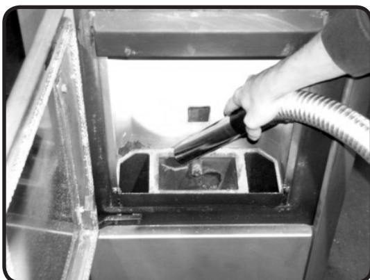
Abb. 14d: Reinigung der Topfhalterung
