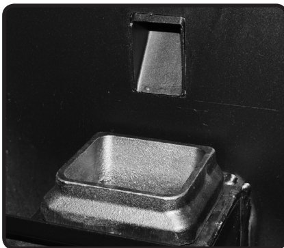
Abb. 8b: Richtig eingesetzter Brenntopf
