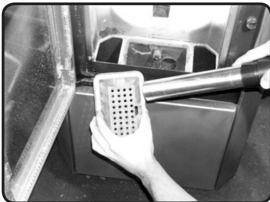
Abb. 14b: Reinigung der Luftöffnungen mit einem Staubsauger
