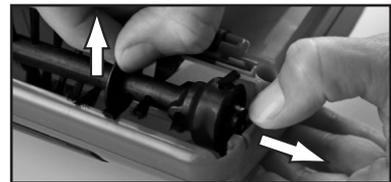
Befestigen Sie die Bürste, indem Sie sie zuerst am festen Ende einführen (1) und dann am flexiblen Riegel (2).
